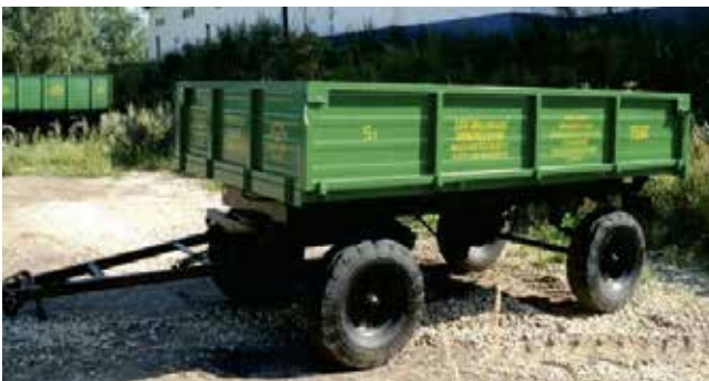
Рис. 1. Тракторные сельскохозяйственные прицепы: а - 2ПТС-4,5 с шинами 9,00-16; б - 2ПТС-6,5 с шинами 11,5/80-15,3
