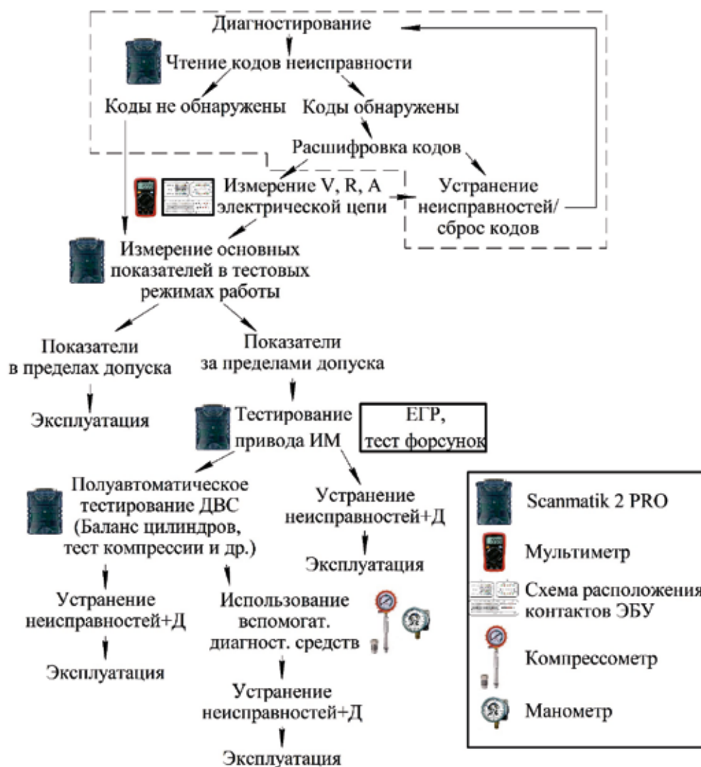
Рис. 3. Схема совершенствования алгоритма диагностирования двигателя путем оценки измерения основных показателей работы двигателя в тестовых режимах
